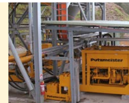
HSP 25100 HPS, válvulas PCF, Power-pack hidráulico HA 400 + 400 E-SP
