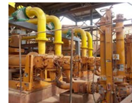
Sistema VPD instalado após uma bomba de pistão HSP para manuseio de rejeitos
