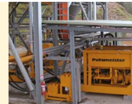
HSP 25100 HPS, PCF válvulas, grupo hidráulico HA 400 + 400 E-SP
